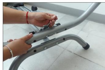
(D) Retirez l'écrou lâche de la vis fixée à la base du pied et insérez la pointe arrondie du câble 4 dans la vis fixe. Serrez l'écrou avec la clé "A". Voir l'image.
