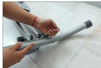
(C) Insérez 2 vis 8 dans la petite barre en "U" 7 (voir tableau). Placez les rondelles 9 et l'écrou 5 et la vis 8 et serrez avec la clé "A". Assurez-vous que c'est serré. Voir l'image.
