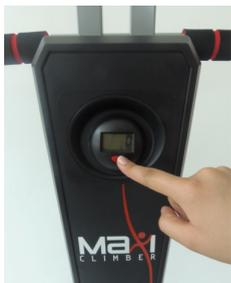
Pour basculer entre les fonctionnalités de chronométrage et enregistrement dans votre écran, faites-le en appuyant sur sur le bouton :
